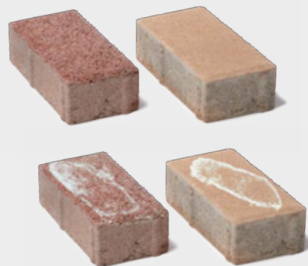
Ukázka povrchu bez a ukázka s cimento-vápenným výkvvětem.
