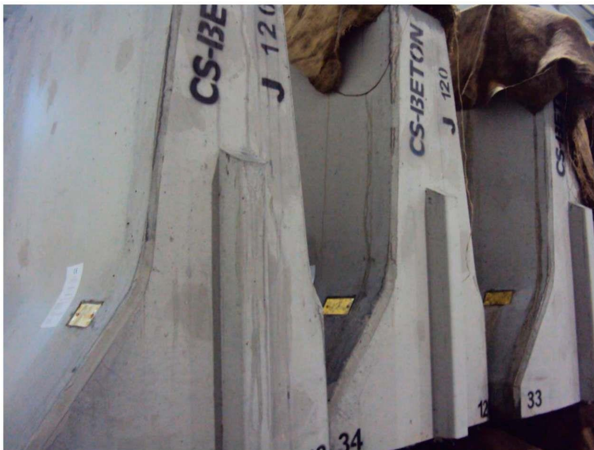
Rysunek 15 – Oznakowanie kolorem na jednej ścianie czołowej każdego elementu
