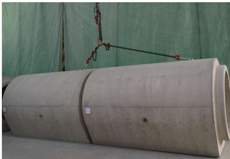
Obrázek č. 8 – Spojování trub pomocí řetězového ukladače
