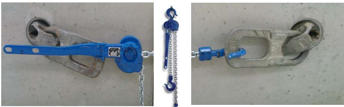
Obrázek č. 5 – Detail uložení pákového zvedáku RZC s článkovým řetězem na jedné straně trouby
